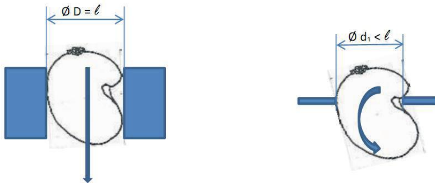
Figure 2. Modes de sortie des noix – Nuts going out modes .
