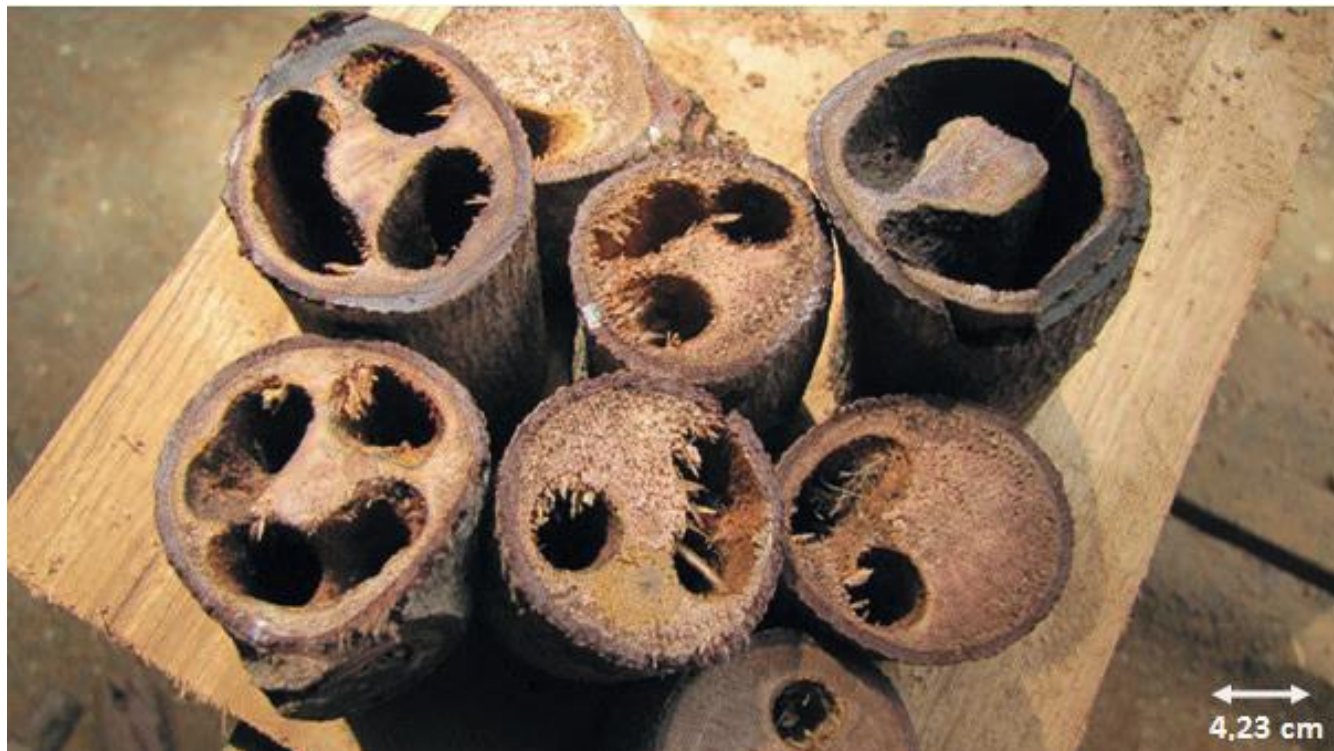
Figure 2. Cross section of cashew wood infested by Apate terebrans (cashew wood borer) – Coupe transversale de bois d'anacardier infesté par Apate terebrans (foreur de bois d'anacardier).
