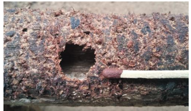
Figure 8. Orifice d'émergence des adultes de D. trifasciata – Exit hole of D. trifasciata .
